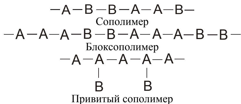
Рис. 6. Схемы строения полимеров: А и Б - различные звенья макромолекул
