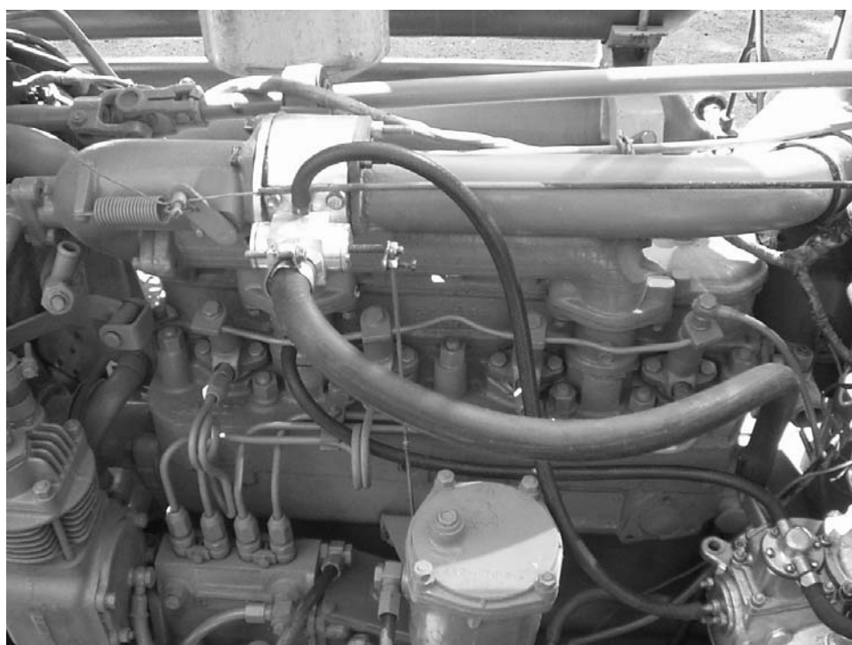
Рис. 4.14. Общий вид системы регулирования газодизельной модификации трактора МТЗ-80/82
