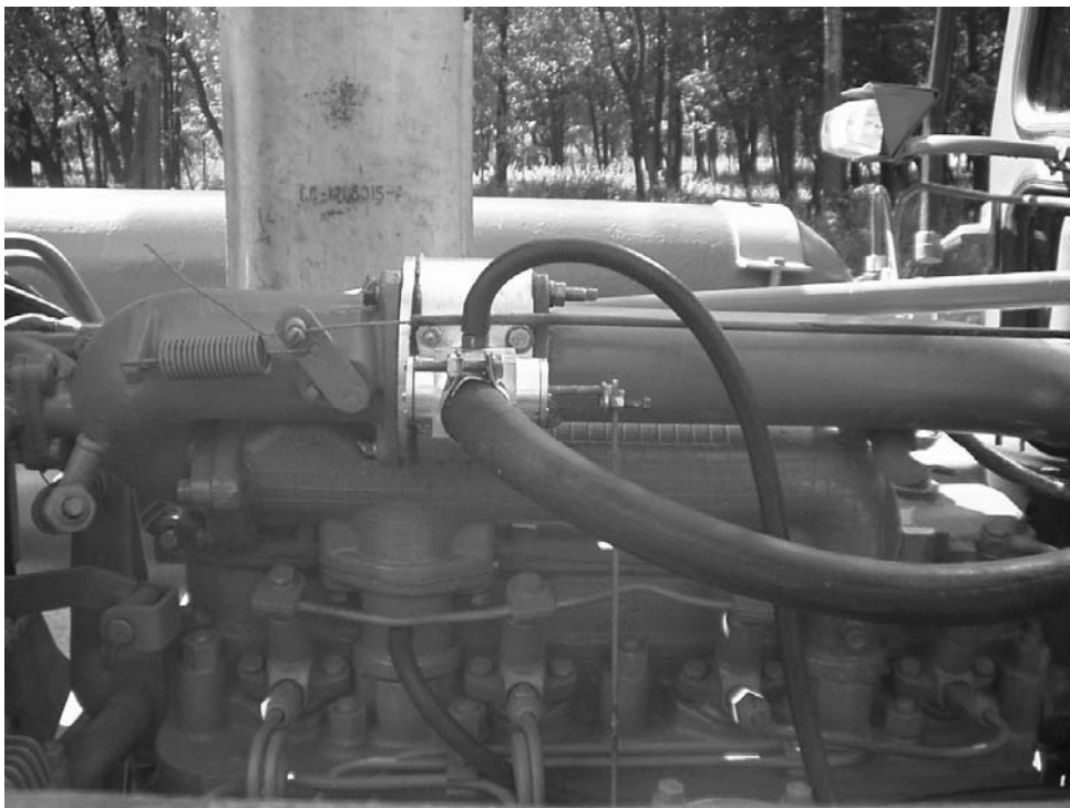
Рис. 4.12. Вид на универсальный газовый смеситель-дозатор с тягой привода газовой заслонки трактора МТЗ-80
