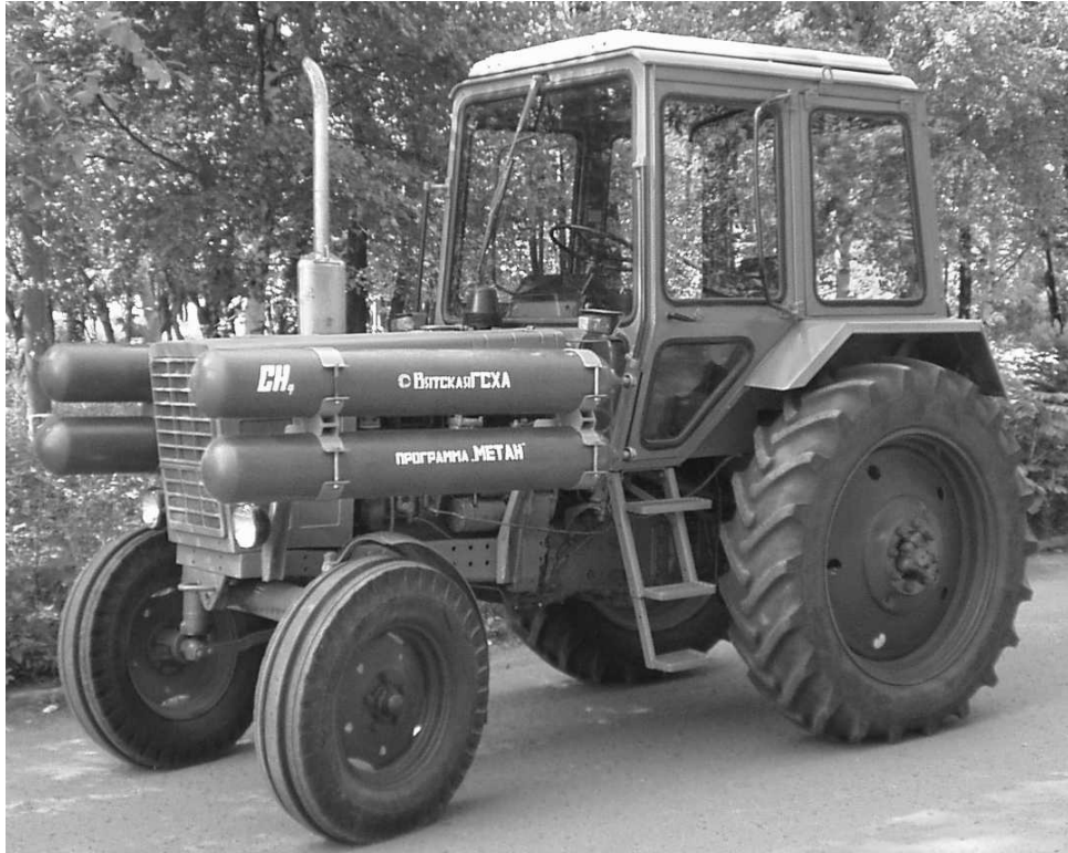
Рис. 4.11. Общий вид трактора МТЗ-80 с системой питания, модернизированной для работы на сжатом природном газе
