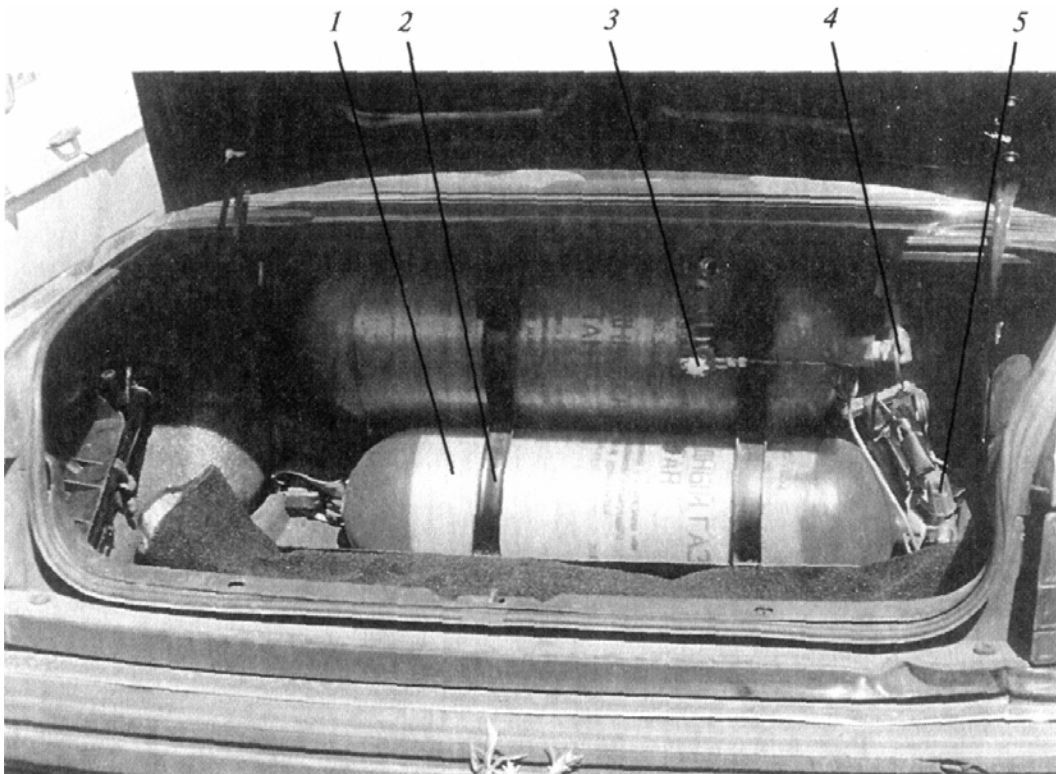
Рис. 5.3. Расположение баллонов КПГ с арматурой в багажнике: 1 – баллон; 2 – хомут; 3 – заправочное устройство; 4 и 5 – баллонные вентили
