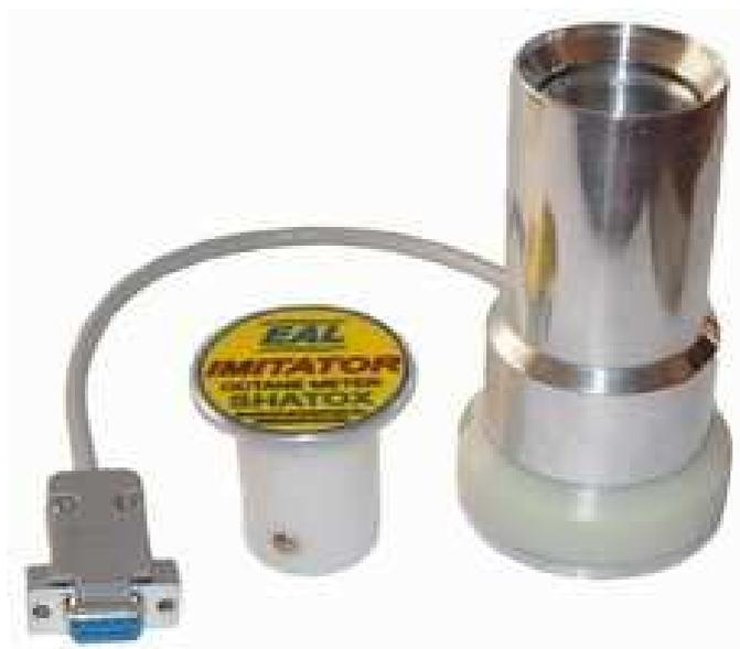
Рисунок 3.1 – Датчики №1, №2 и имитатор пробы прибора
