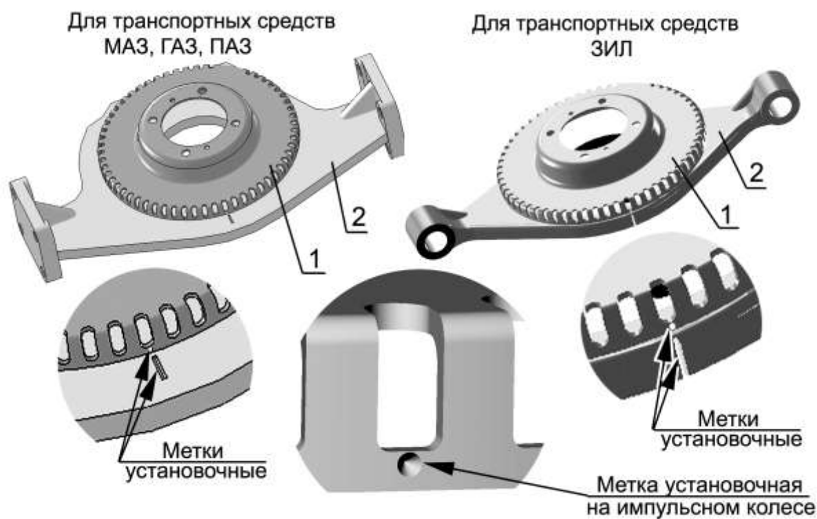
Рисунок 18 – Метки установочные: 1 – колесо импульсное (конструктивное исполнение – б; 2 – опора передняя)
