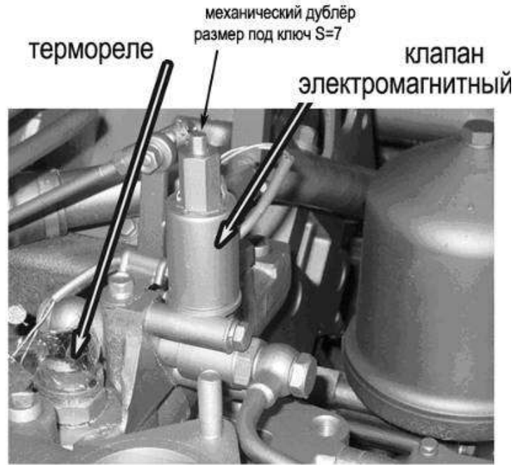
б) устройство включения привода вентилятора
