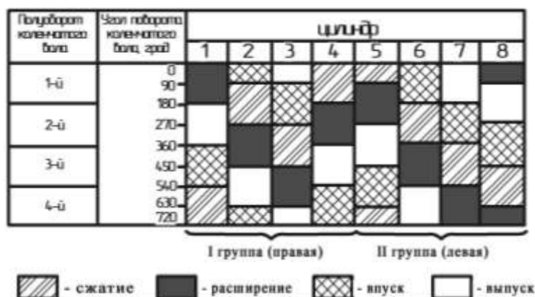
Рисунок 3 - Чередование тактов в дизелях ТМЗ - V-образный восьмицилиндровый дизель при порядке работы 1-5-4-2-6-3-7-8
