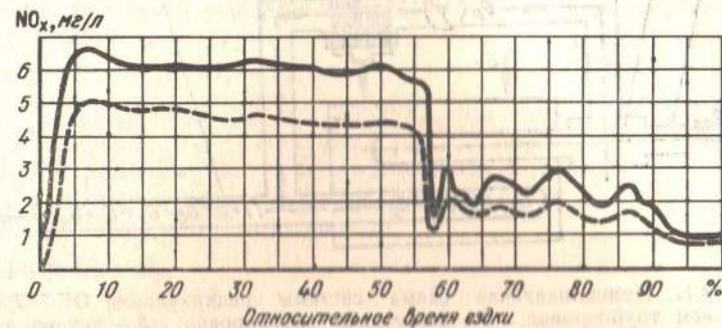
Рис. 8.10. Результаты эксплуатационных испытаний системы подачи воды: — — без подачи воды; — — — — с подачей воды
