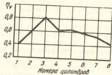
Рис. 7.12. Динамика изменения коэффициентов наполнения по отдельным цилиндрам двигателя ЗИЛ-130
