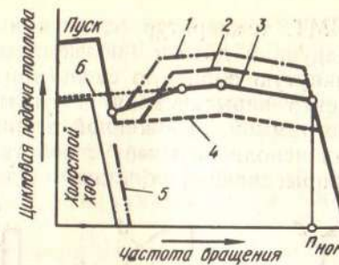
Рис. 7.3. Характер действия различных систем ТНВД на характеристики дизеля: 1 — ограничитель дымности (ограничивает ход рейки, корректирует давление наддува); 2 — система коррекции (ограничивает ход рейки, корректирует подачу топлива по абсолютному давлению); 3 — цикловая подача топлива; 4 — система высотного корректора (ограничивает ход рейки, корректирует подачу топлива); 5 — ограничитель холостого хода с температурным корректором (ограничивает частоту вращения холостого хода, обеспечивает температурную коррекцию); 6 — температурный регулятор (регулирует количество топлива, впрыскиваемого при запуске, с температурной коррекцией)
