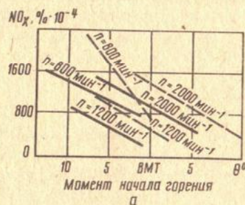
Рис. 18. Влияние топлива на содержание оксидов азота в ОГ дизеля:
