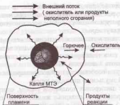
Рис. 2.1. Схема взаимодействия капли МТЭ и окислителя в цилиндре двигателя
