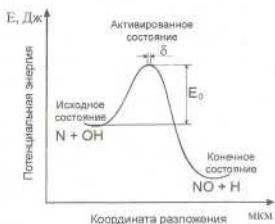
Рисунок 2.10 - Потенциальный барьер химической реакции, соответствующий активированному состоянию
